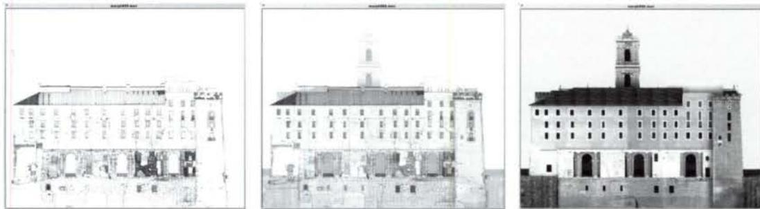
*La sequenza mostra, sfruttando la dissolvenza fra le immagini, l'aderenza del prospetto del modello infografico al rilievo fotogrammetrico sottolineando che il dato di partenza di ogni modello deve essere quanto più preciso possibile.*
